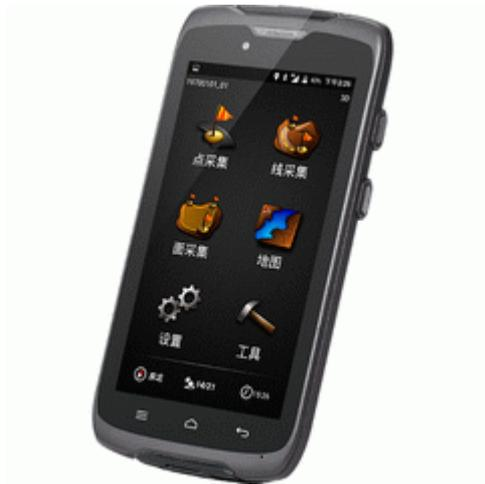
A3S 坚固型北斗智能终端搭载骁龙 64 位四核处理器，支持 BDS、GPS、GLONASS 全星座卫星系统接收，全面兼容移动、联通、电信 4G 网络，优异的工业级性能是电力、林业、国土等行业理想的数据采集终端。
