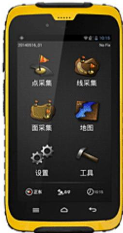
任我游 A5 是合众思壮公司最新推出的坚固型北斗智能终端，产品采用 Android 智能操作系统，支持北斗+GPS+GLONASS 三系统全星系 GNSS 卫星接收，TD-LTE/FDD-LTE 双 4G 五模网络通讯，满足移动互联网时代大数据量传输的需求，是移动互联网时代坚固型智能终端的理想选择。
